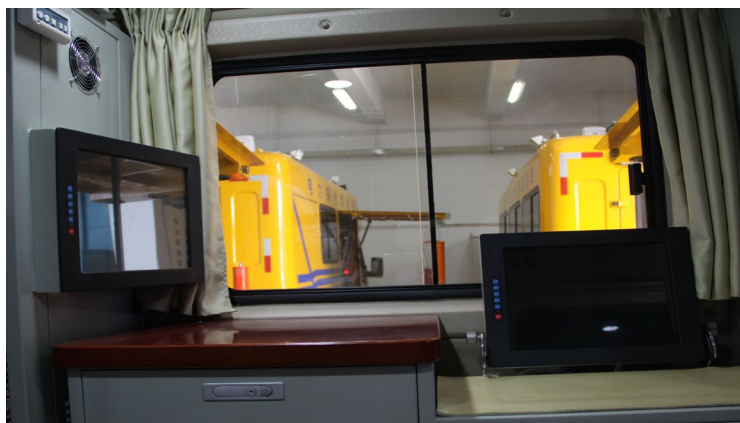
操作位正面与集控机架背面同侧的监视窗
